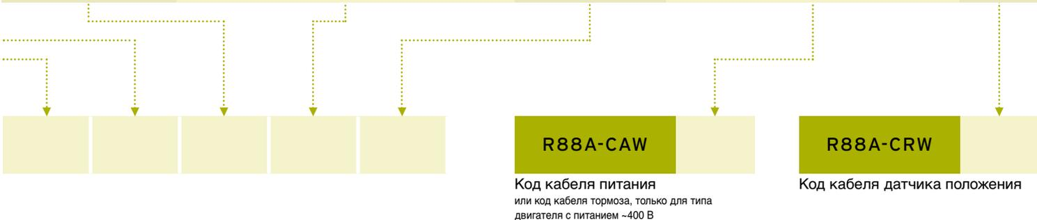
Следует отметить, что xx= 03, 05, 10, 15 или 20 (обозначает длину кабеля в метрах)
