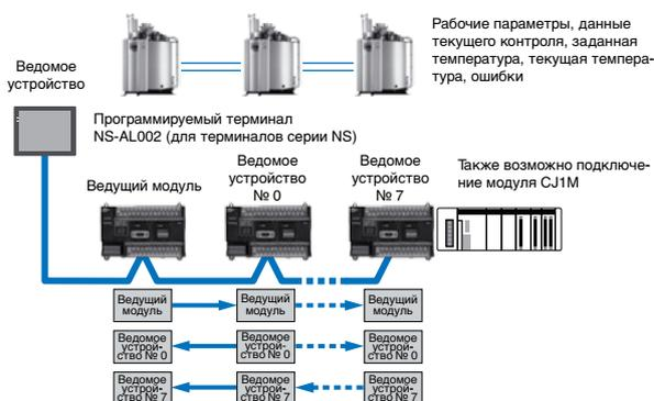
Для обмена данными между несколькими программируемыми терминалами серий NS/NT и одним ведущим модулем CP1H можно использовать протокол NT Link 1:N. Каждый из терминалов считается одним ведомым узлом.
