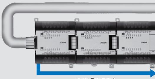
При подключении семи модулей расширения ввода/вывода можно получить до 320 входов/выходов.
