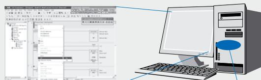
Программу CX-Simulator можно использовать совместно с CX-Programmer для отладки системы в реальном времени даже без подключенного ПЛК.
