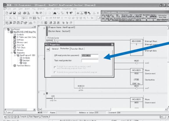
Защита программ обеспечивается паролем, который можно установить в системе CX-Programmer (при включенном ПЛК).
