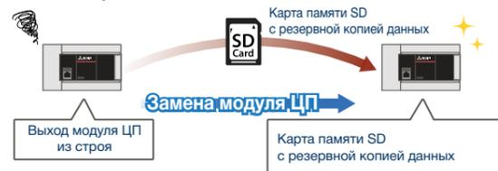
Если используется функция автоматического обмена модуля ЦП, данные с карты памяти SD автоматически восстанавливаются при включении питания или при перезагрузке модуля ЦП. В случае неисправности модуля ЦП его можно немедленно заменить, не используя персональный компьютер.
