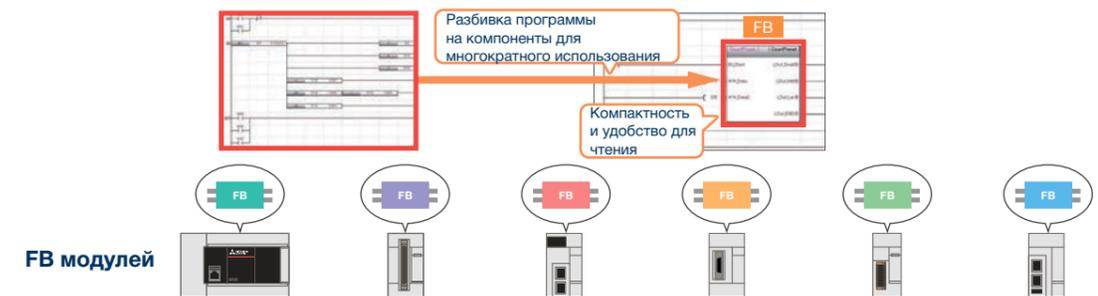
FB \*\* для всех модулей расширения уже включены в GX Works3.
