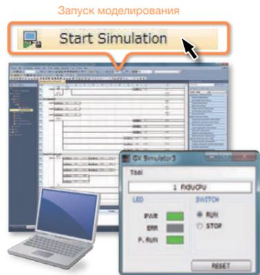
Моделирование работы модуля Simple Motion \*\*
