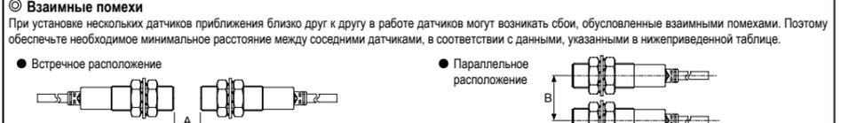
Если датчики монтируются на металлической панели, необходимо защитить датчики от сбоев в работе, вызываемых находящимися рядом металлическими объектами, за исключением целевого объекта срабатывания. Поэтому необходимо соблюдать минимально допустимое расстояние согласно данным, указанным в нижеприведенной таблице.
