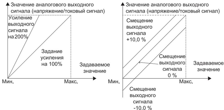
Рисунок 10.10-1. График усиления и смещения аналогового сигнала
