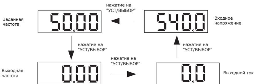
Рисунок 5.5-2. Переключение контролируемых параметров
