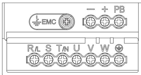
Рисунок 4.4-3. Расположение клемм
