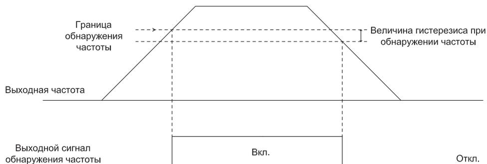
Рисунок 10.10-3. Определение частоты
