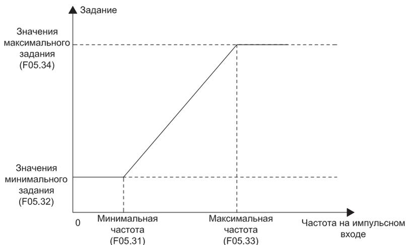
Рисунок 10.9-9. Обработка частоты сигнала, поступающего на импульсный вход
