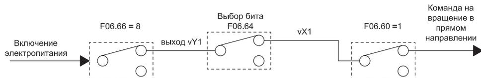
Рисунок 10.10-6. Схема автоматического запуска при включении питания
