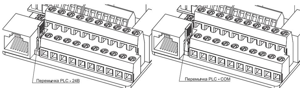
Рисунок 4.7-3. Схема подключения перемычек «+24 В», «PLC», «COM»
