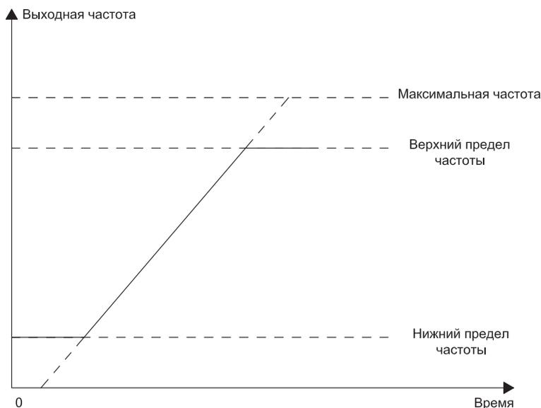
Рисунок 10.5-2. График, отображающий нижний и верхний пределы частот
