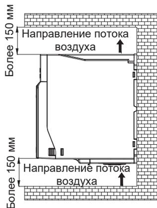
Рисунок 3.5-1. Положение преобразователя частоты и необходимое пространство
