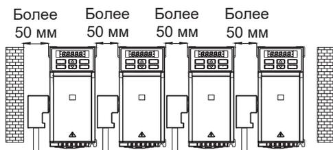
Расстояние между устанавливаемыми преобразователями частоты не менее 50 мм (с коммуникационной картой расширения)
