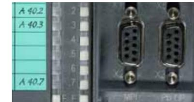
Встроенные интерфейсы MPI, RS-485 (PtP или PROFIBUS DP) и Ethernet PG/OP во всех процессорных модулях
